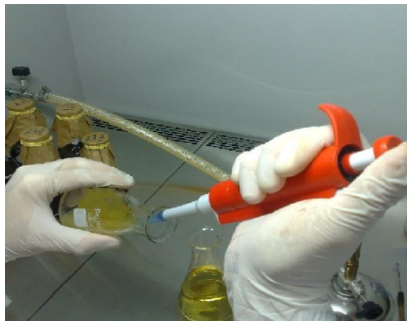
Figura 6 - Inoculação da bactéria nos efluentes para verificação do comportamento microbiano
