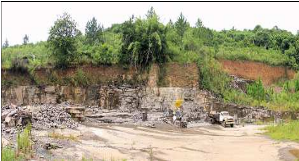
Figura 6 – Extração da Lavra de Basalto no Distrito Mineiro de Nova Prata, Disjunção Tabular Horizontal, na forma de Lajes
