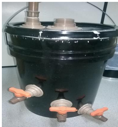
Figura 7 – Protótipo de reator anaeróbio
