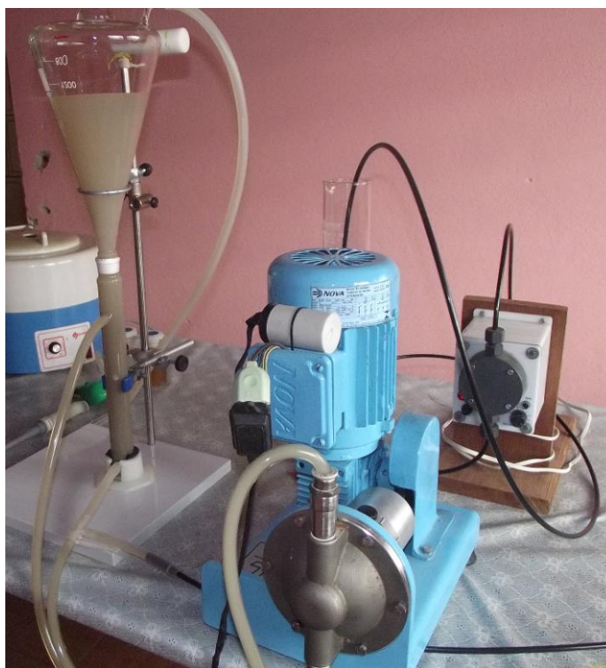
Figura 11 - Reator de leito fluidizado em vidro com bombas de alimentação e reciclo.
