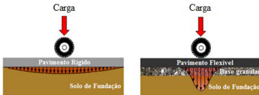
Figura 2 - Distribuição das tensões nos diferentes tipos de pavimento
