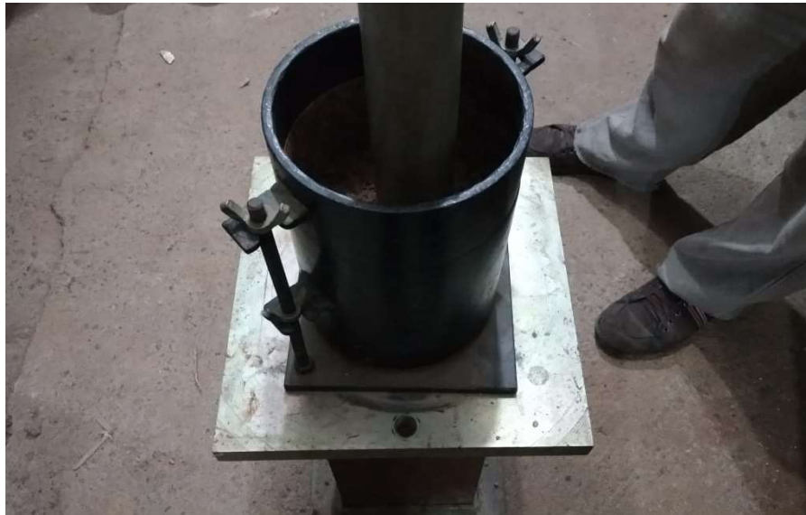
Figura 14 - Compactação de corpo de prova
