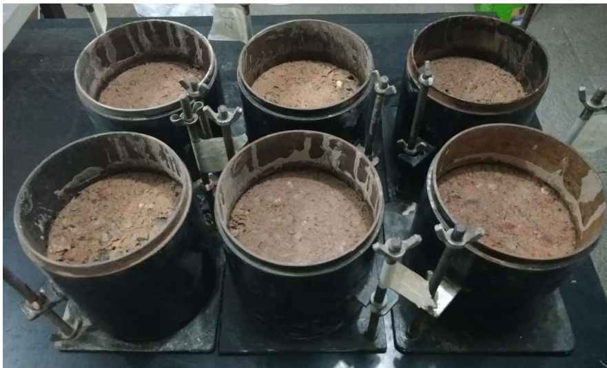
Figura 31 - Corpos de prova após compactação
