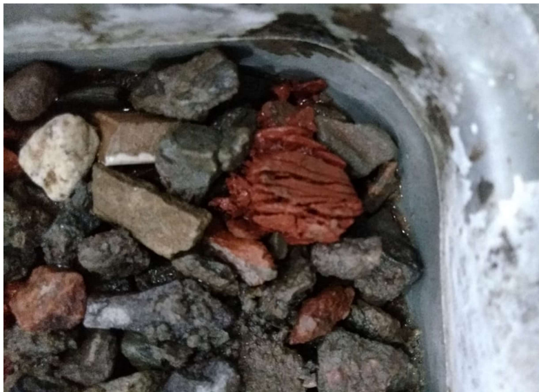
Figura 29 - Agregado após ser submetido ao ensaio de sanidade
