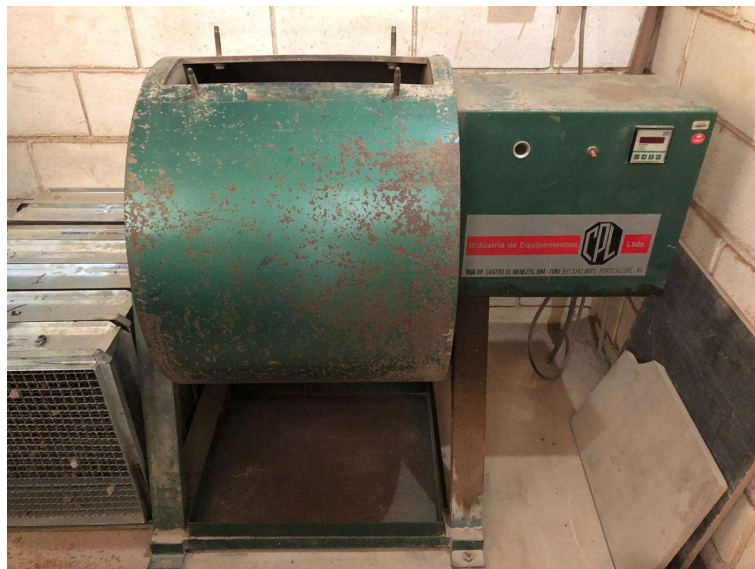
Figura 12 - Máquina de abrasão “Los Angeles”
