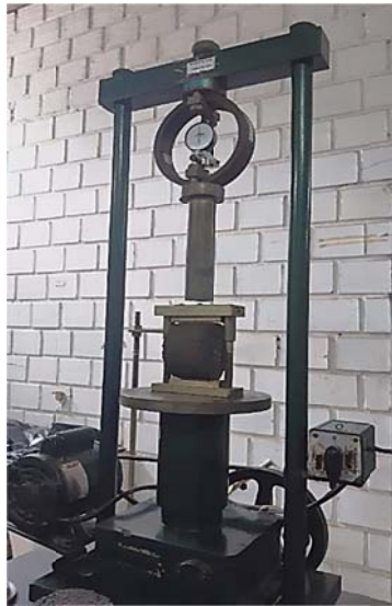
Figura 36 - Ensaio de RTDC
