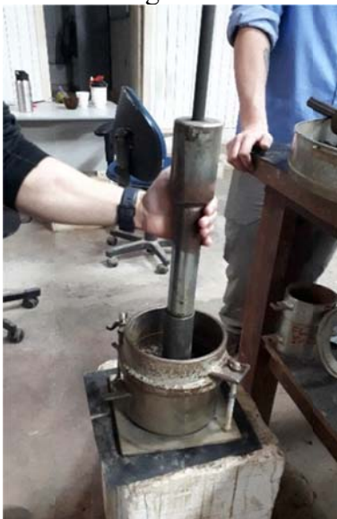
Figura 30 - Compactação e moldagem do CP
