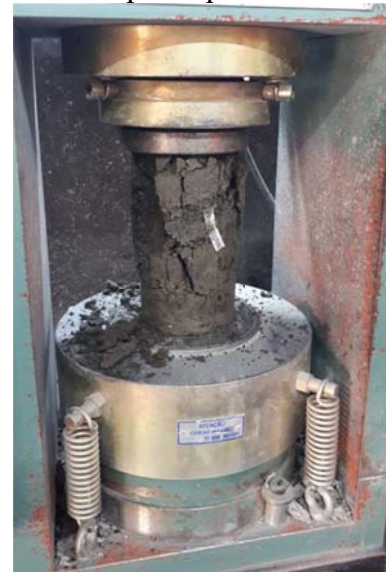
Figura 35 - Corpo de prova após ruptura
