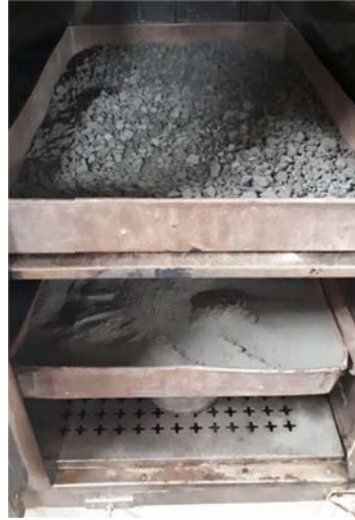
Figura 20 - Secagem dos agregados
