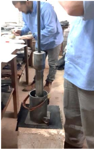
Figura 33 - Moldagem e compactação do CP
