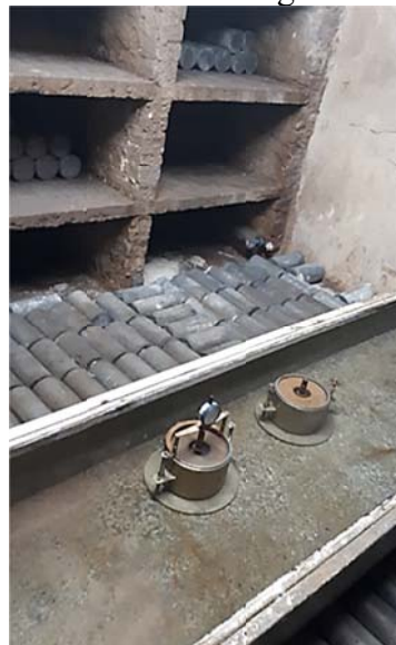
Figura 31 – Corpos de prova imersos em água
