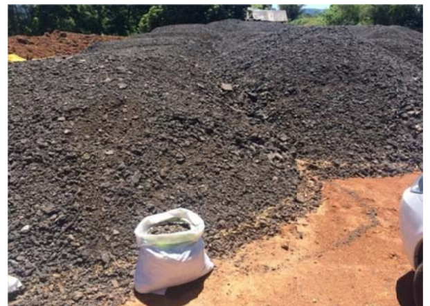
Figura 15 - Coleta do material fresado
