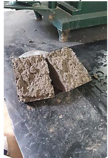
Figura 38 - Detalhe separação em duas partes
