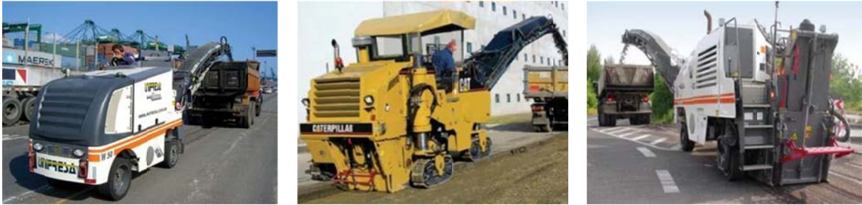
Figura 6 - Equipamentos de fresagem de pequeno, médio e grande porte
