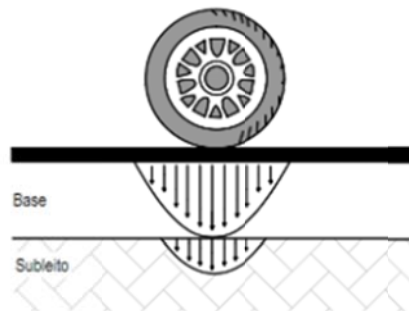
Figura 3 - Campo de tensões pavimento flexível
