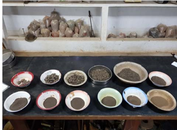
Figura 24 – Granulometria do fresado retido em cada peneira
