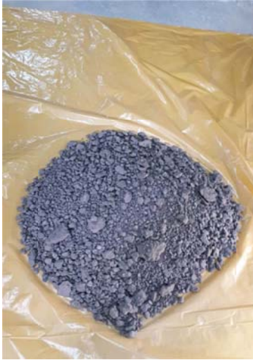
Figura 19 - Secagem do fresado
