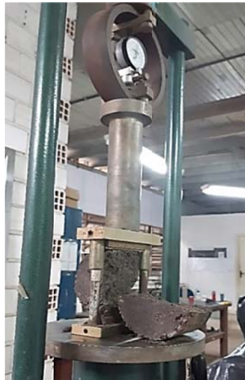
Figura 37 - Ruptura do CP
