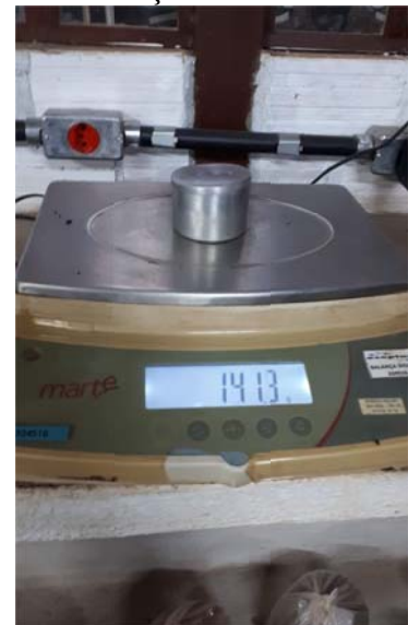
Figura 29 - Pesagem para obtenção da umidade
