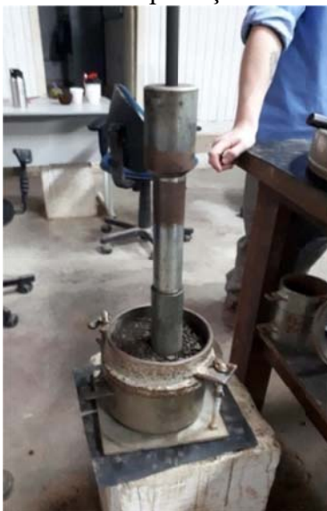
Figura 27 - Ensaio de compactação
