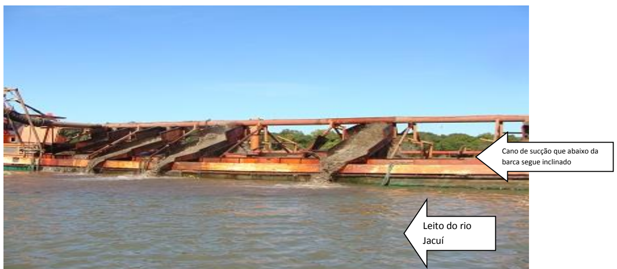
Figura 3 – Embarcação em atividade de processo de extração de areia no rio Jacuí
