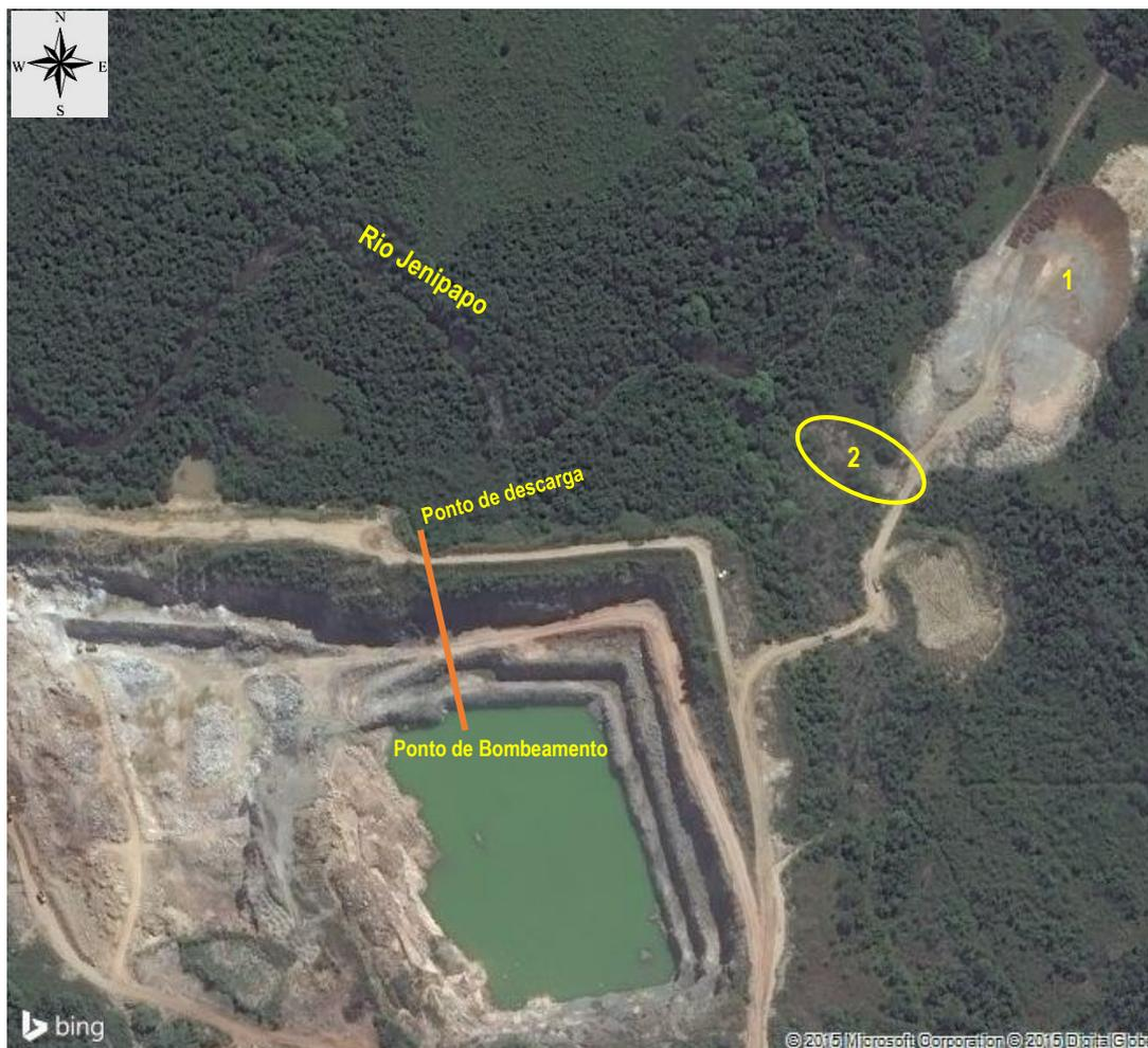
Legenda: 1- Pilha de material estéril e rejeitos; 2- Ocorrência de carreamento de solo da pilha de material estéril e rejeitos.
