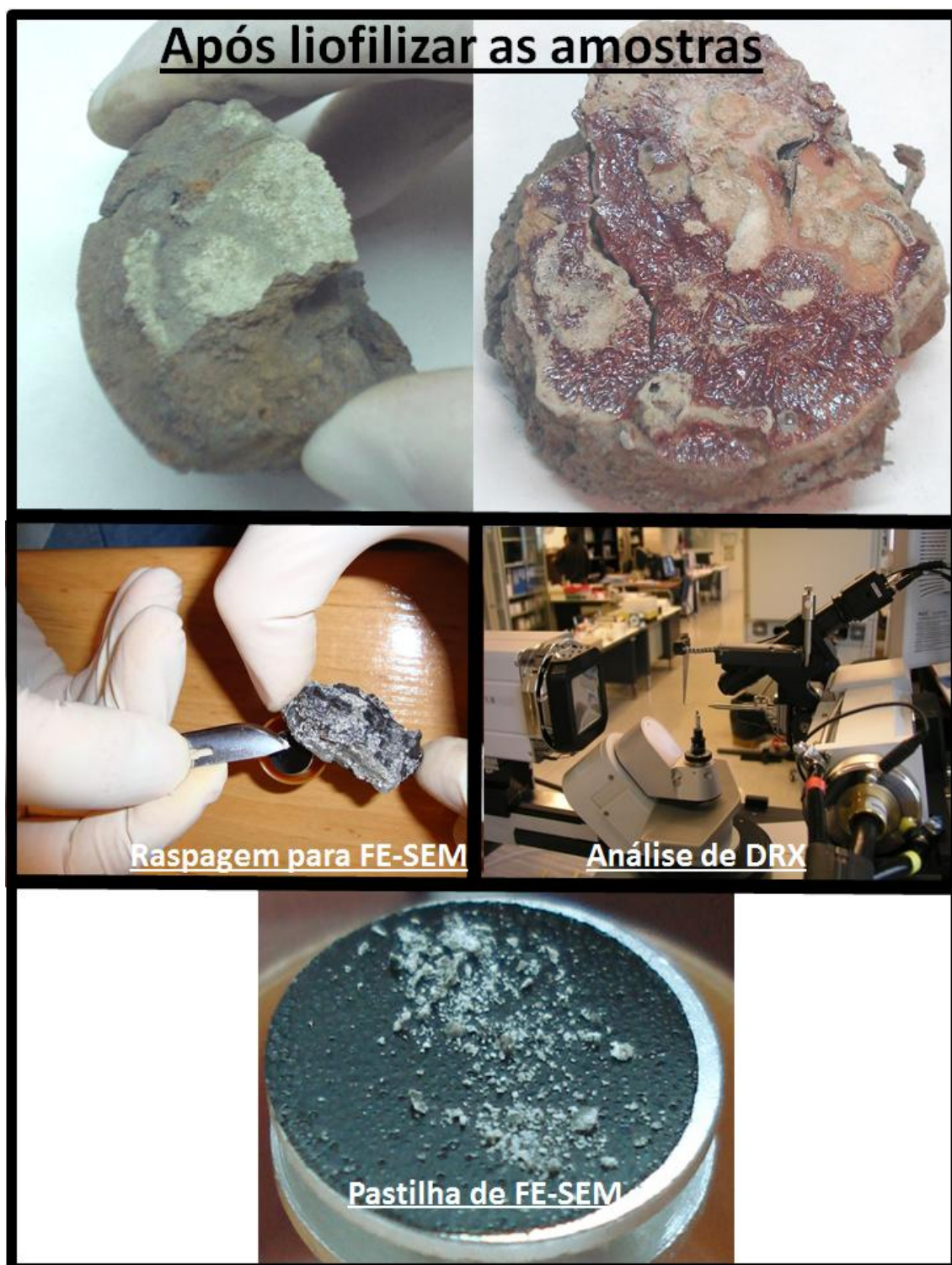
Figura 8: Ilustrações dos passos para preparação das amostras por métodos não destrutivos após liofilização.
