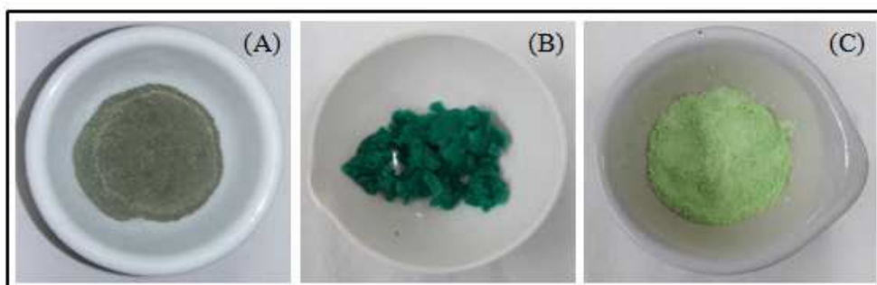
Figura 32 - Precipitados relacionados a calcinação da amostra de \text{Ni(OH)}_2/\text{Ni}_2\text{P}_2\text{O}_6 \cdot 12\text{H}_2\text{O} convertida em \text{NiO} (A); no ensaio de produção de \text{NiSO}_4 antes da secagem (B); e no ensaio de produção de \text{NiSO}_4 após a secagem (C).
