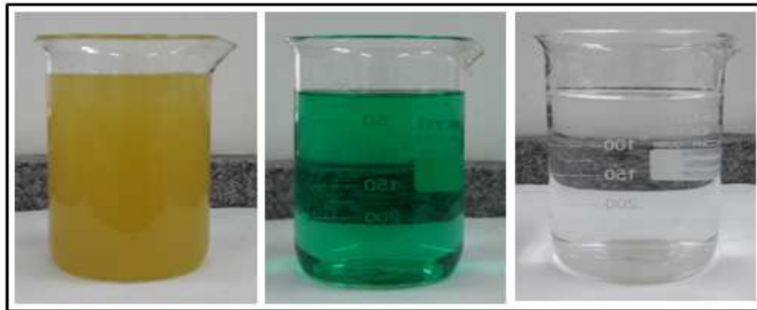
Figura 31 - Aspecto da amostra de efluente nas diferentes fases do estudo. Efluente bruto (à esquerda); efluente ozonizado e enriquecido com 10,86 \text{ g.L}^{-1} de níquel (centro); efluente tratado, após ensaio de precipitação em pH 12,00 (à direita).
