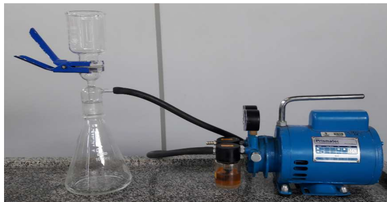
Figura 10 - Sistema de filtração a vácuo com membrana filtrante de acetato de celulose, utilizado para a remoção dos precipitados das amostras ozonizadas.
