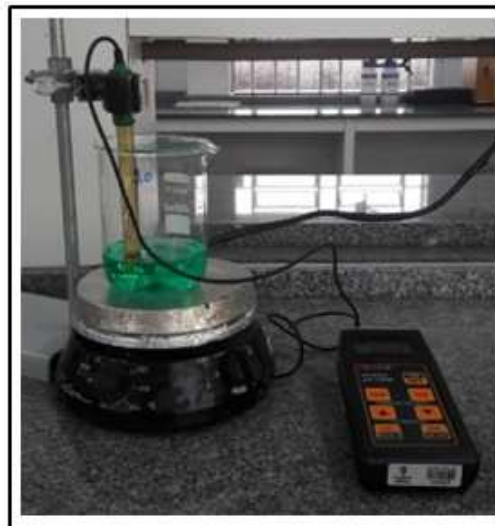
Figura 12 - Sistema empregado nos ensaios de precipitação do Ni nas diferentes faixas de pH.
